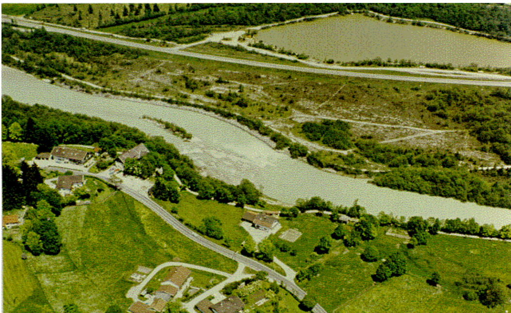
Bild: Nagelfluhrippe bei Fkm 210,0, linksufrig in den 60 iger Jahren zu einer Rauhsteinrampe ausgebaut
