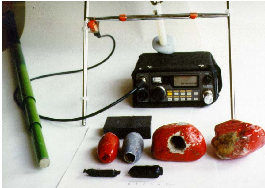
Bild: Wesentliche Ausrüstungsgegenstände für die Radiotracermessung (mit Minisendern bestückte Geschiebekörner, Empfänger, Peil-Antenne)
