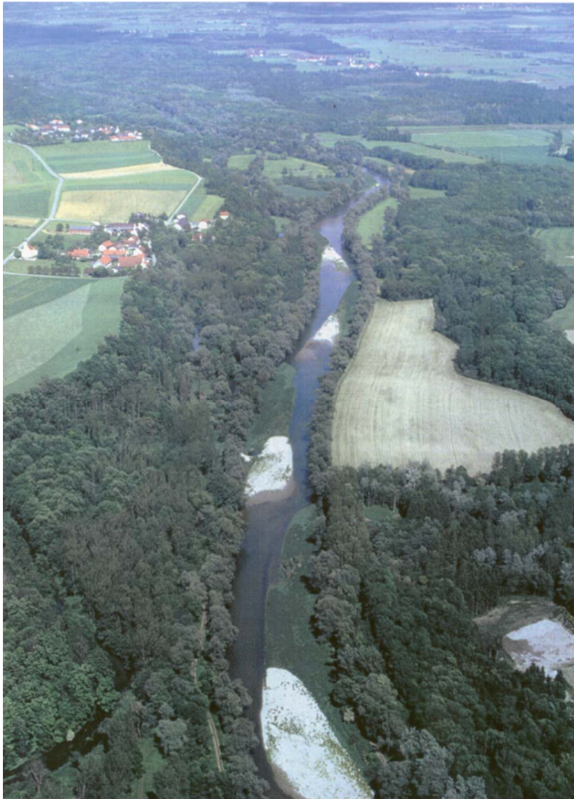
Bild: Relativ schmale und eingetieftete Flußbetten mit hohen Sohlschubspannungen
