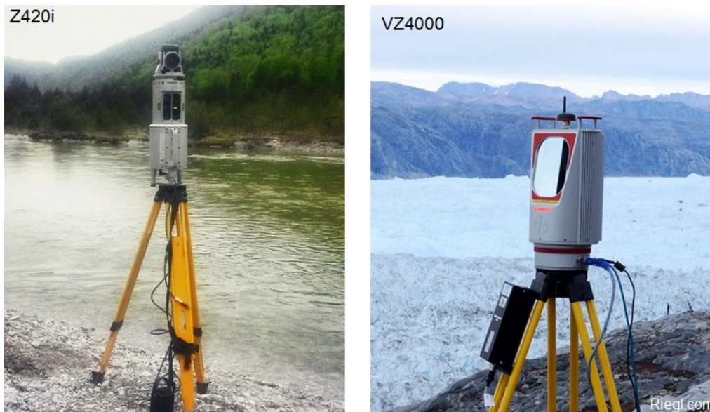
Abbildung 2.2: Laserscanner Z420i (links, eigene Abbildung 2015) und VZ4000 (rechts, Riegl.com) von Riegl
