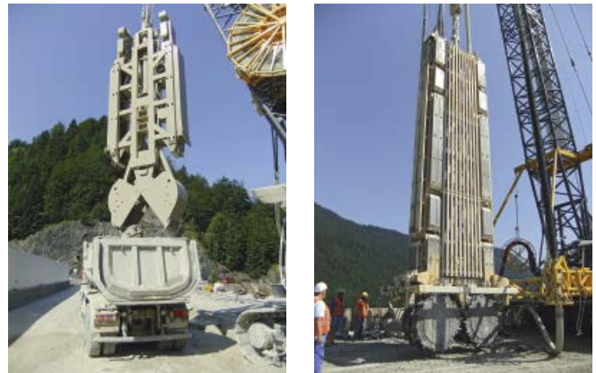
Abb. 4: Schlitzwandgreifer und Schlitzwandfräse der Fa. Bauer Spezialtiefbau
